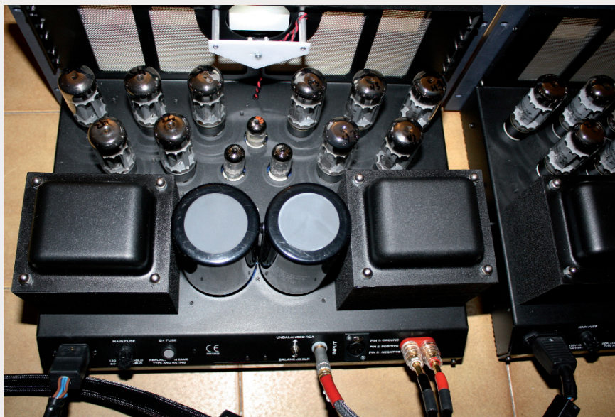
Vista dall'alto e senza griglie di protezione: 250 W "sotto vetro", due pesanti trasformatori e condensatori grossi come lattine di birra
