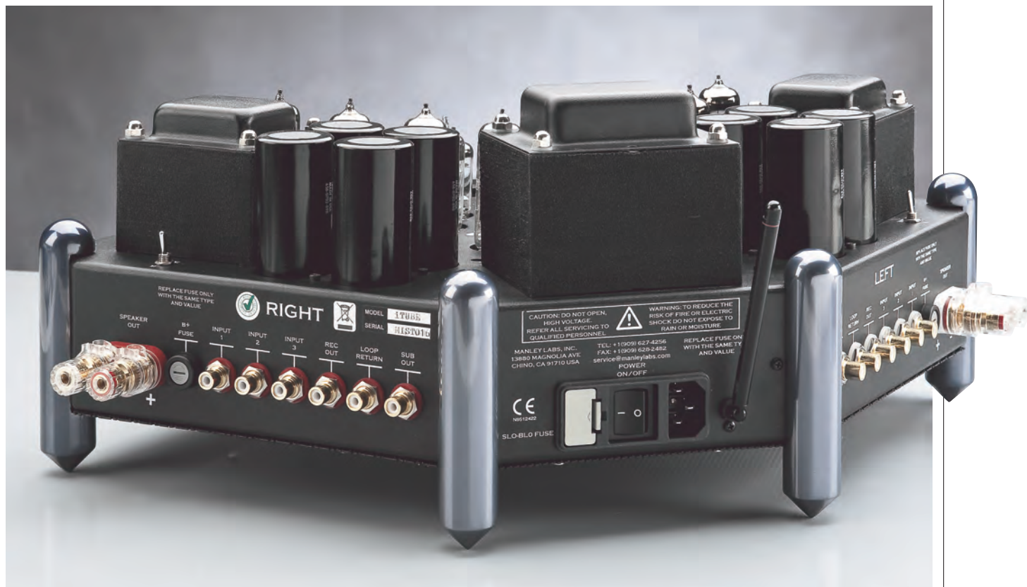
Al centro la vaschetta IEC dell'alimentazione e l'antenna del telecomando, a destra e a sinistra i connettori d'ingresso ed i morsetti per i diffusori.
